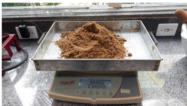
Figura 19: Pesagem para medição da umidade da areia
