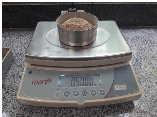
Figura 21: Determinação da massa específica da areia pelo Método de Chapman
