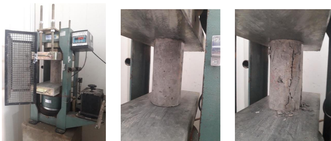
Figura 26: Ensaio de resistência à compressão
