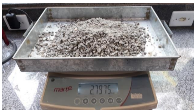
Figura 20: Pesagem para medição da umidade da brita
