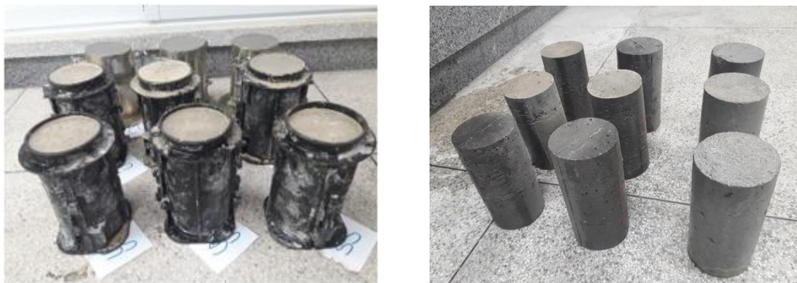
Figura 24: Moldagem e desforma dos corpos de prova
