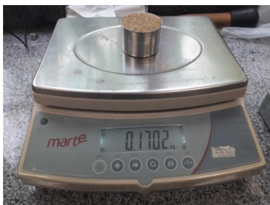
Figura 22: Determinação da massa unitária da areia e da brita
