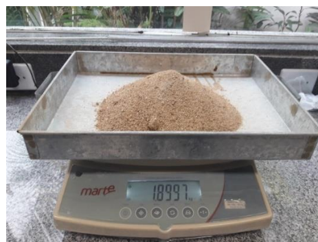
Figura 19: Pesagem para medição da umidade da areia
