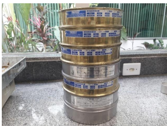
Figura 23: Peneiras de análise granulométrica e moldes para corpos de prova
