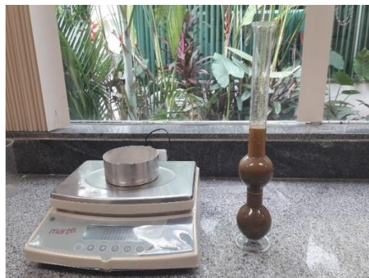
Figura 21: Determinação da massa específica da areia pelo Método de Chapman
