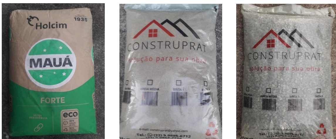
Figura 17: Cimento, areia e brita utilizados
