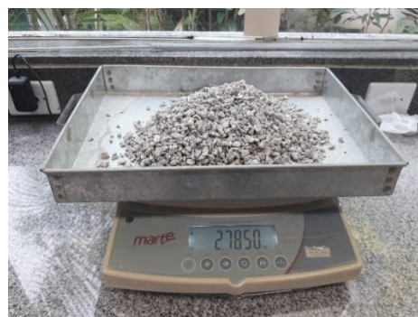
Figura 20: Pesagem para medição da umidade da brita
