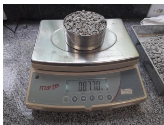
Figura 22: Determinação da massa unitária da areia e da brita
