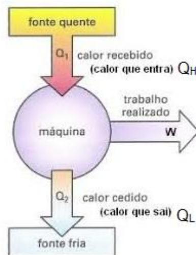
Figura 2: Fluxo de Energia no Funcionamento das Máquinas Térmicas
