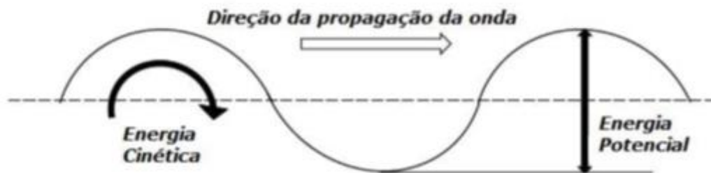
Figura 16: Esquema de ilustração da energia cinética e da energia potencial de uma onda
